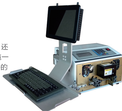
不同长度的线缆可以一次性完成下线（剥线）
